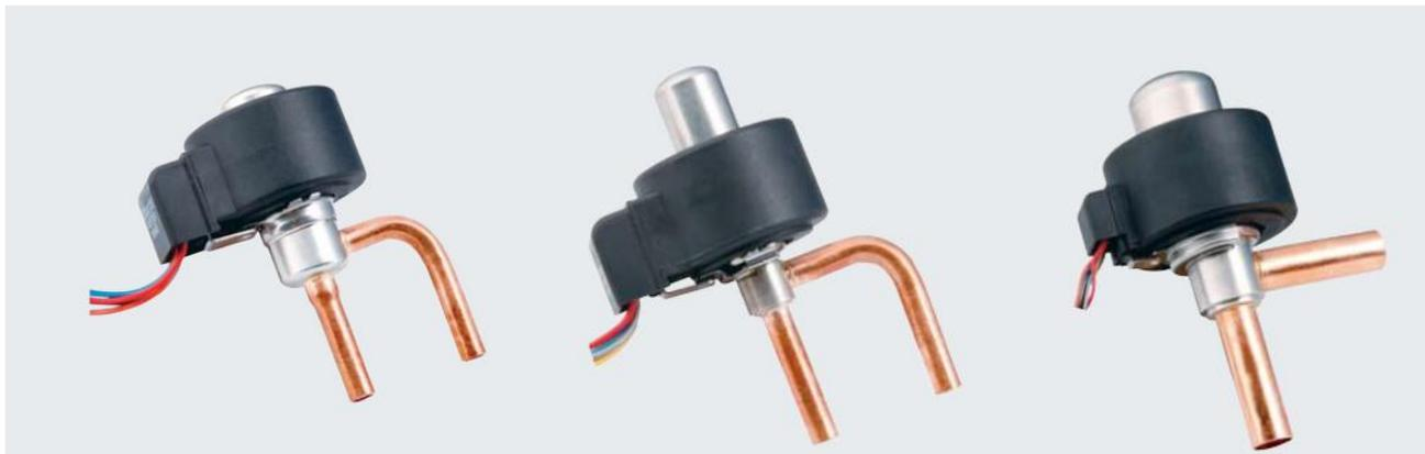
Les Détendeurs électroniques DPF de la série T / S sont conçus pour une utilisation dans les systèmes de climatisation et de réfrigération ou de pompes à chaleur. La vanne contrôle le débit de réfrigérant et optimise ainsi le fonctionnement du système et permet un contrôle précis de la température et de faire des économies d'énergie. La vanne peut aussi être utilisée également à l'aspiration pour contrôler la pression d'évaporation. Ces détendeurs permettent un fonctionnement bidirectionnel.
