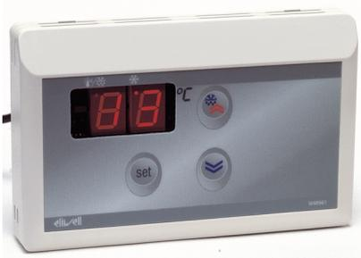
Le WM 961 est un régulateur de température électronique à un point de consigne, destiné à des applications dans le secteur de la "réfrigération". Le modèle "A" dispose d'une sortie pour le raccordement d'un relais d'alarme à distance tandis que le modèle "B" dispose d'un buzzer pour la signalisation d'alarme.
