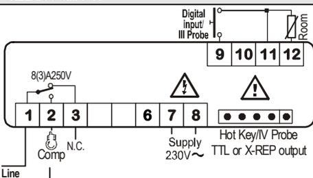
Alimentation 9-40Vdc : se connecter aux bornes 7 et 8.
