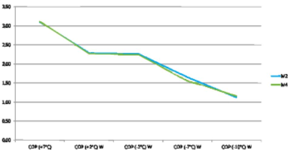
Pour améliorer les performances de chauffe, les pompes à chaleur monobloc utilisent l'inversion de cycle qui n'arrête pas la machine pendant le dégivrage. Cela augmente la capacité de chauffage de 40%.
