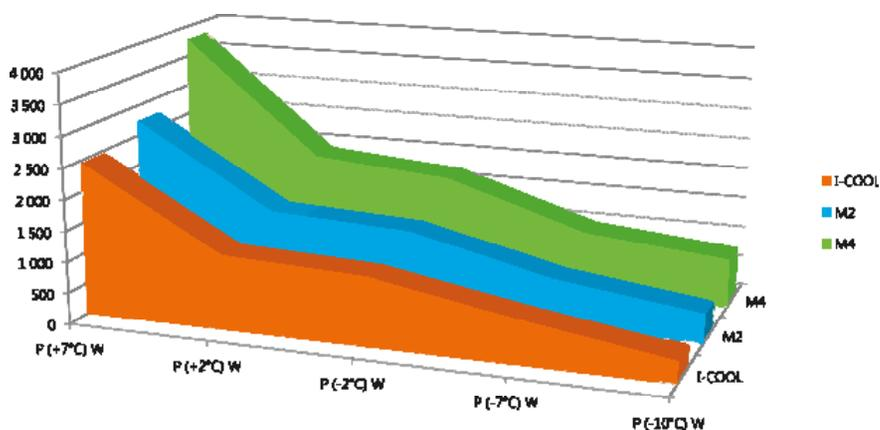
Les résultats ci-contre démontrent que le monobloc produit du chauffage même sous des températures extrêmes. La plage de fonctionnement du monobloc est très large, de -15°C à +52°C. De plus, le modèle M4 est équipé d'une fonction TURBO, fournissant un apport de chaleur supplémentaire. Cette fonction est très utile surtout dans des régions où les températures peuvent descendre jusqu'à -15°C.
