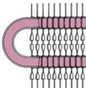
Tube du fluide réfrigérant de forme ronde. Pour ces condenseurs il est possible de fournir, sur demande expresse du client, un diffuseur en plastique type **C**.
