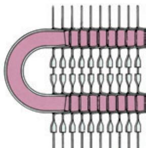
Tube du fluide réfrigérant de forme ronde. Pour ces condenseurs il est possible de fournir, sur demande expresse du client, un diffuseur en plastique type **C**.
