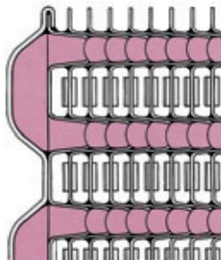
Tube du fluide réfrigérant de forme ovale. Structure très compacte avec un rapport élevé puissance/volume. Pour ces condenseurs il est possible de fournir, sur demande expresse du client, un diffuseur en plastique type **CF**.
